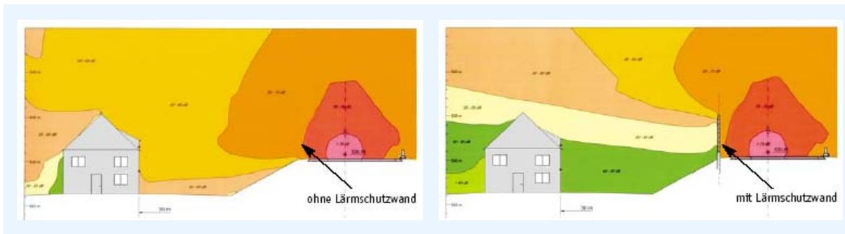
Die Pegelminderung ist u.a. abhängig von der Wand- bzw. Wallhöhe und von der Breite der linienförmigen Schallquelle. Straßen, insbesondere Autobahnen, sind meistens breiter als Eisenbahnstrecken. Die Ausbreitung ihres Schalls lässt sich deshalb schlechter durch Abschirmungen eindämmen.
